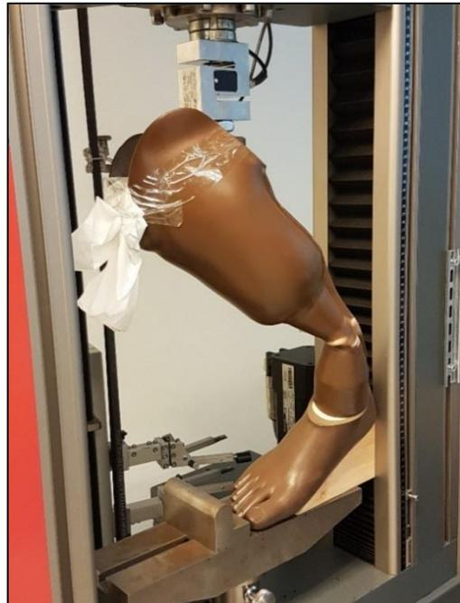
Figura 5: Protesi deformata plasticamente
