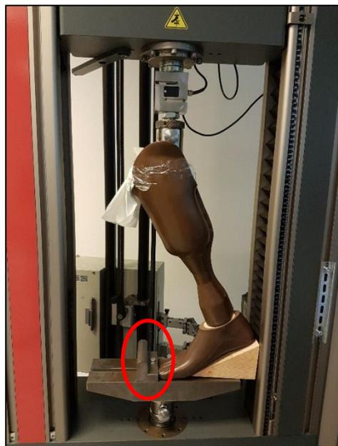
Figura 4: Inserimento cuneo e bloccaggio della protesi
